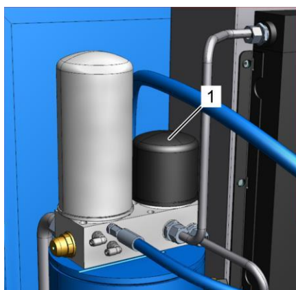
Рис. 46: Демонтаж фильтра охлаждающей жидкости
