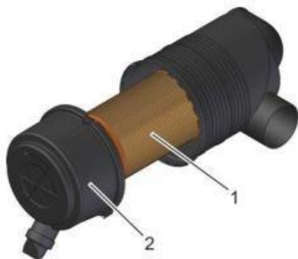
Рис. 38. Разборка корпуса воздушного фильтра
