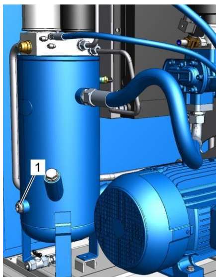
Рис. 32: Проверка уровня охлаждающей жидкости через смотровое отверстие
